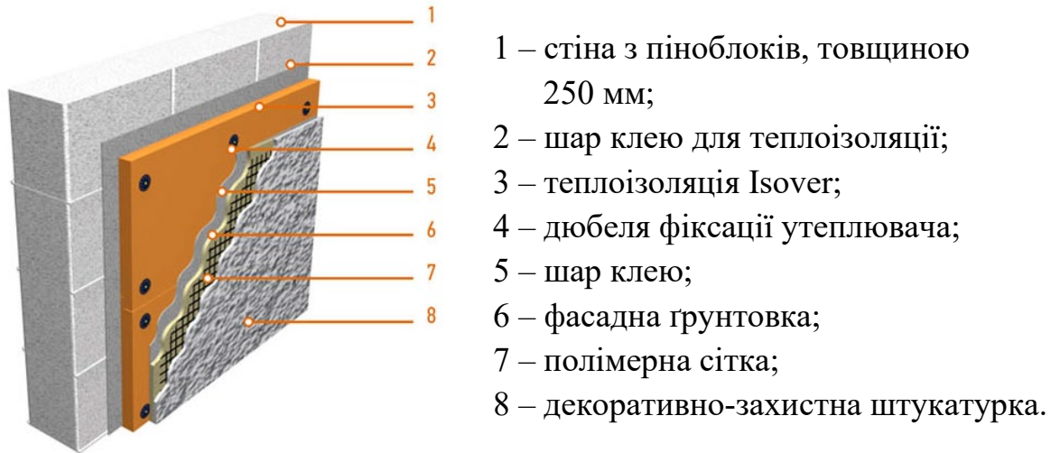
Рис.2.5. Конструкція зовнішніх самонесучих стін.
