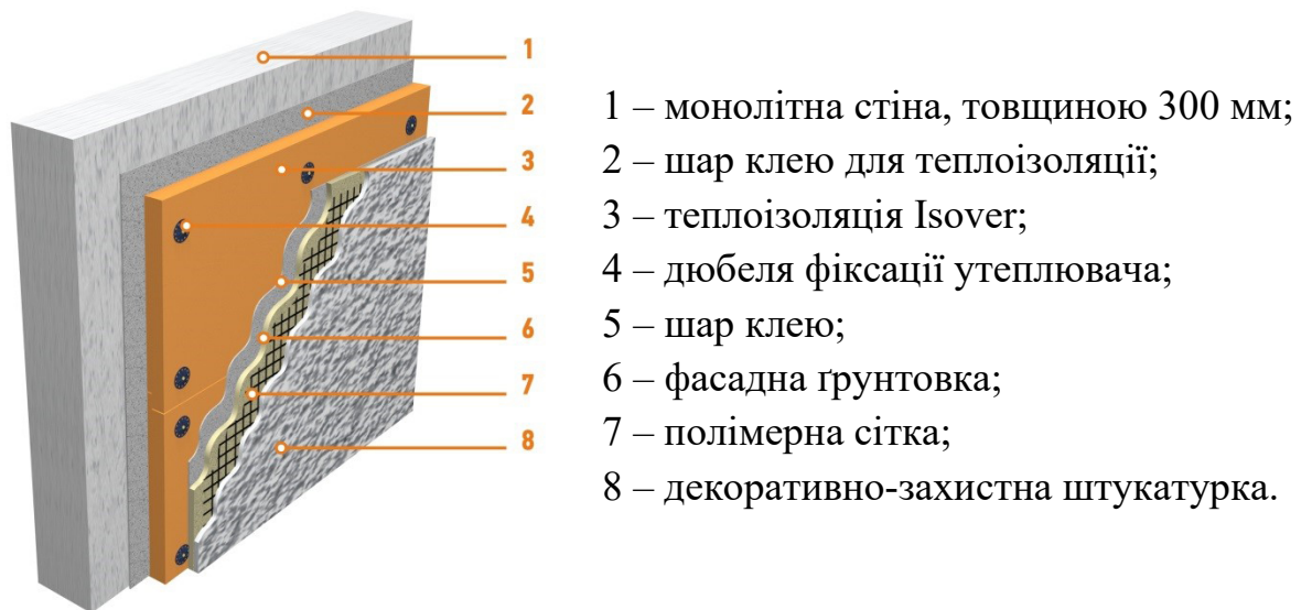
Рис.2.4. Конструкція зовнішніх несучих стін.
