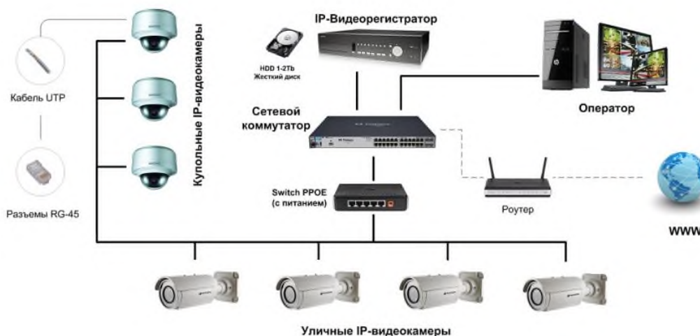
Рис. 2.1 «Класичний» варіант системи відеоспостереження
