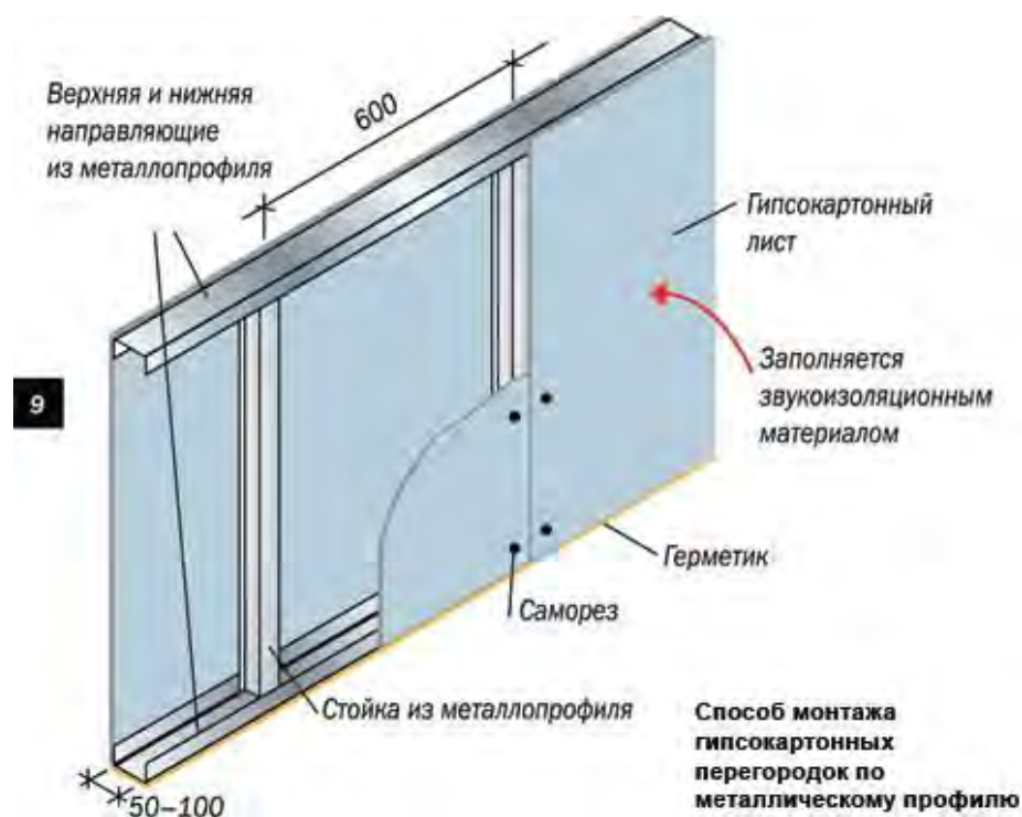
Рис.2.7 Монтаж гіпсокартонних перегородок
