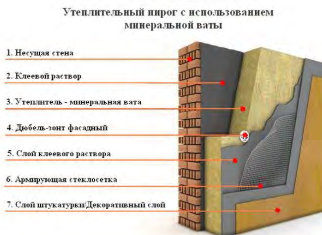
Рис.2.6 Схема зовнішньої стіни
