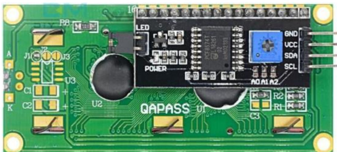
Рис. 3.6 Адаптер I2C для LCD 1602 2004
