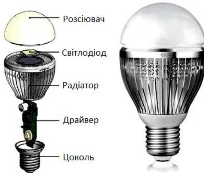
Рис.1 Конструкція світлодіодної лампи
