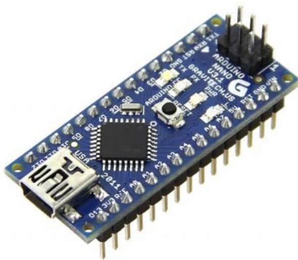
Рис. 1.8. Зовнішній вигляд плати Arduino Nano
