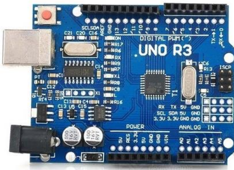
Рис. 1.5 Зовнішній вигляд плати Ардуіно
