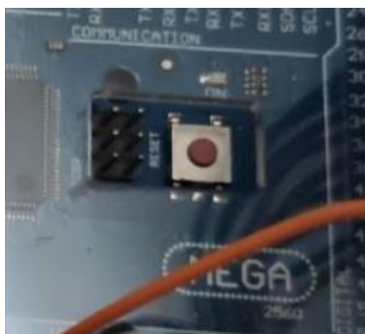
Рис. 3.15. Червона кнопка перезавантаження Arduino Mega
