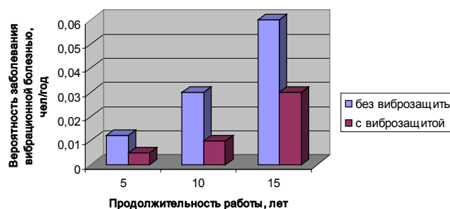
Рис. 2. Зависимость вероятности заболевания вибрационной болезнью от продолжительности работы с пневматическим ручным молотком
