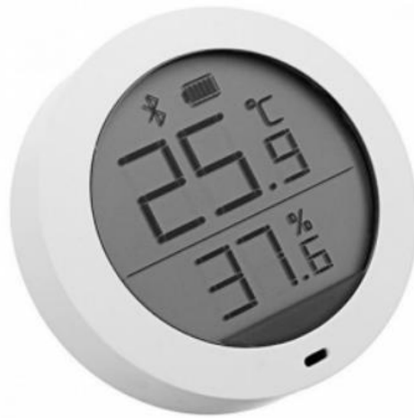
Рис.1.2. Приклад датчика температури та вологості повітря
