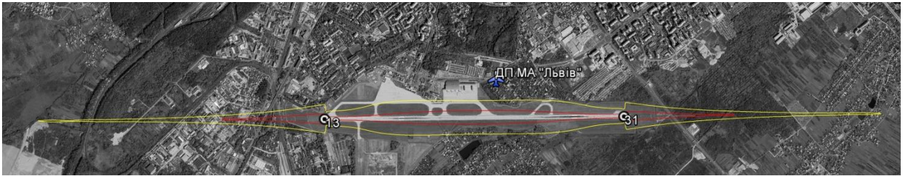
Рис. 1. Рекомендовані межі зон громадської безпеки аеропорту Львів: жовтий (зовнішній) контур – R=10-8 ; червоний (внутрішній контур) – R=10-6 .
