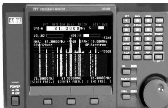
Ilustracja 2.71. Odbiornik skanujący SR2000 [213]
