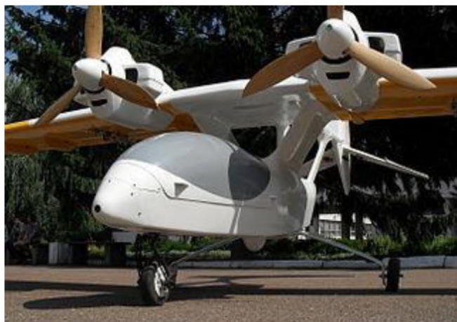
Ilustracja 4.2. Bezzałogowy system latający M-7D „Sky Patrol”
