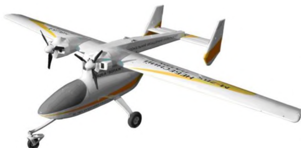
Ilustracja 4.1. Bezzałogowy system latający M-7B5 „Sky Patrol”
