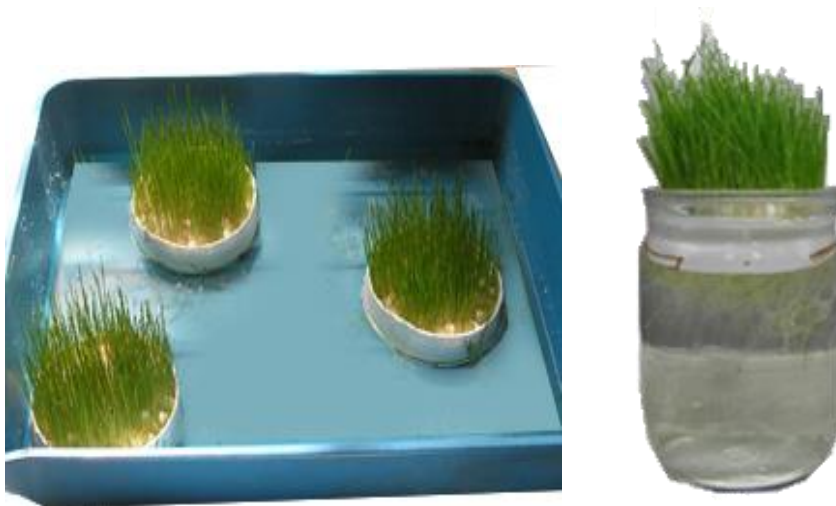
Рис. 2. Общий вид опыта по определению сорбционной способности мини-биоплато
