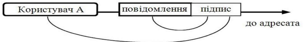
Рис. 1.3. Цифровий підпис як частина повідомлення
