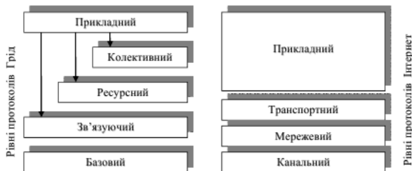
Рис. 1.1. Рівні архітектури протоколів Grid і їх відповідність рівням архітектури протоколів Інтернет
