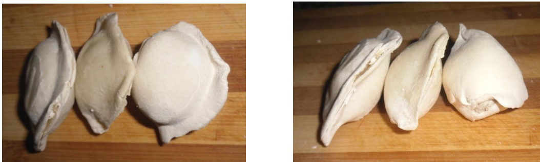
Рис.3. Розшаровування країв виробу, виконаного насадкою-прототипом.
