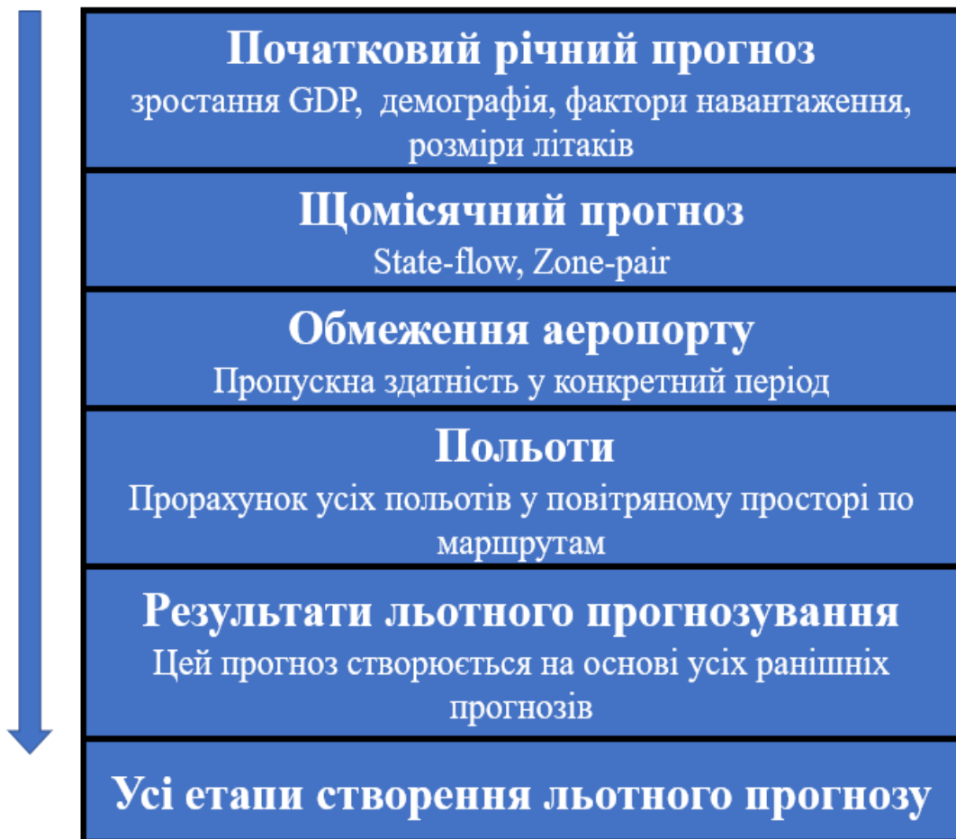
Рисунок 1.3 – Етапи та вхідні дані для обрахунку (прогнозування) пропускної здатності повітряного трафіку
