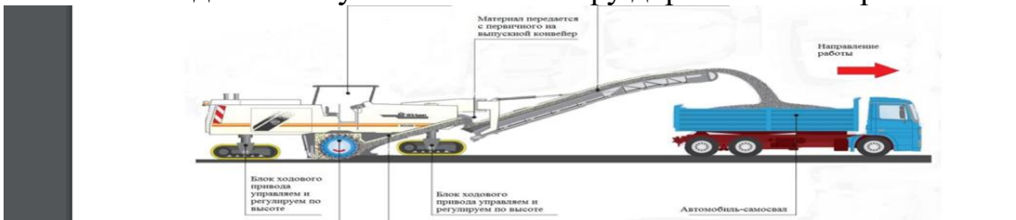
Рис. 5.1 Схема роботи дорожньої фрези з навантаженням шматків дробленого асфальтобетону в автомобіль-самоскид
