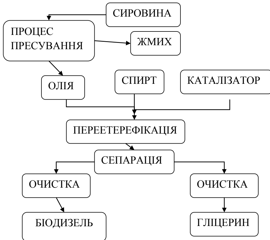
Рис.1.1. Принципова схема виробництва біодизелю, де гліцерин отримують як побічний продукт
