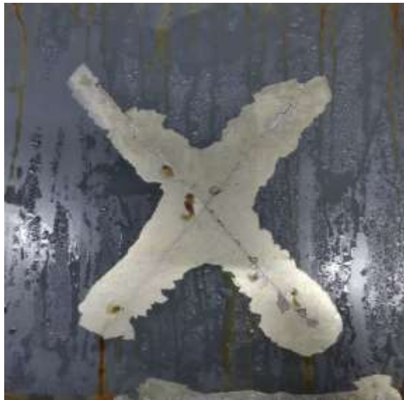
Рис. 3.7.2 Зразок №1 сталі 08КП після випробування на деламінацію лакофарбового покриття з металевим шаром із цирконієвих сполук
