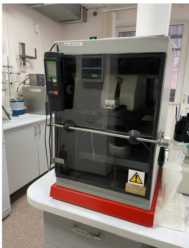
Рис. 2.3 Високочастотна поршнева установка HFRR (High Frequency Reciprocating Rig) Технічні характеристики приладу зазначено нижче (Табл.2.2).
