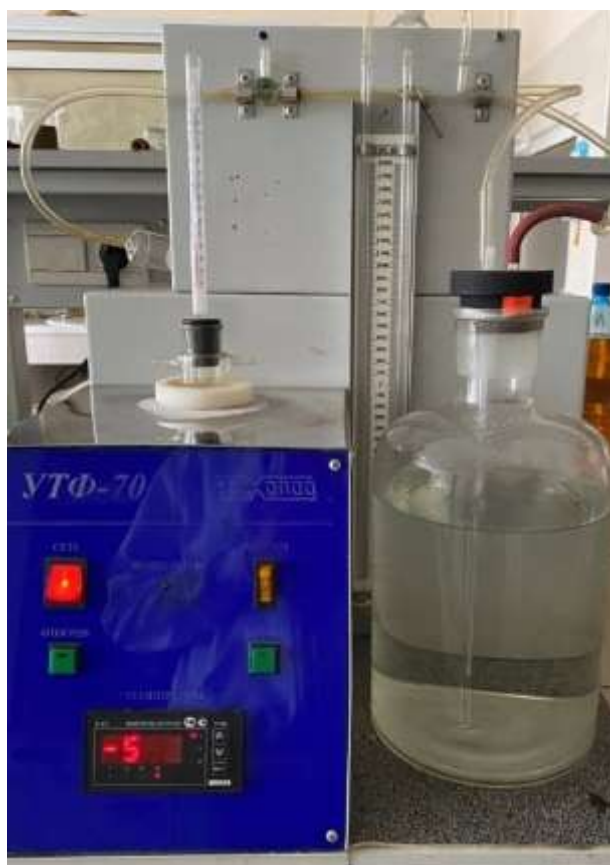
Рис.3.12 Визначення температури кристалізації на приладі УТФ-70
