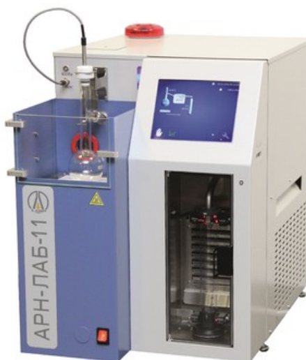
Рис. 2.3. Апарат АРН-ЛАБ-11, для вимірювання фракційного складу.
