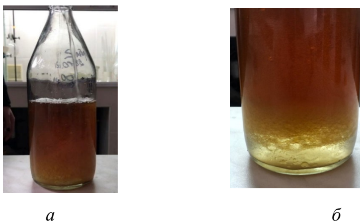
Рис. 3.3. Моделювання обводнення біокомпоненту: а – загальний вигляд, б – розшарування продукту
