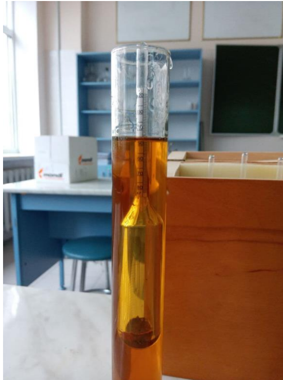
Рис.3.1 – Вимірювання густини мастильних матеріалів за допомогою ареометра.
