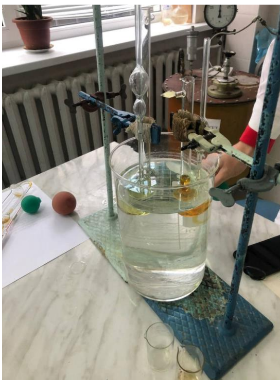
Рис. 3.2 – Вимірювання в'язкості олив за допомогою віськозиметра
