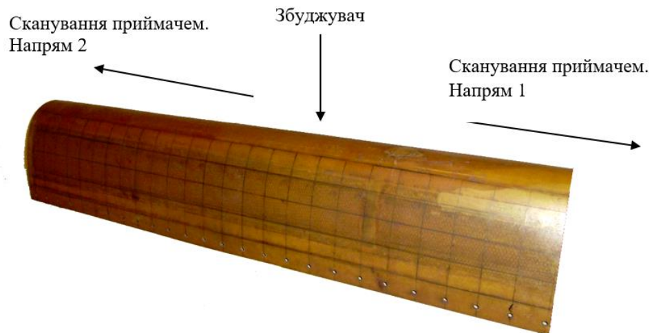
Рисунок 3.8 Фрагмент конструкції крила з координатною сіткою
