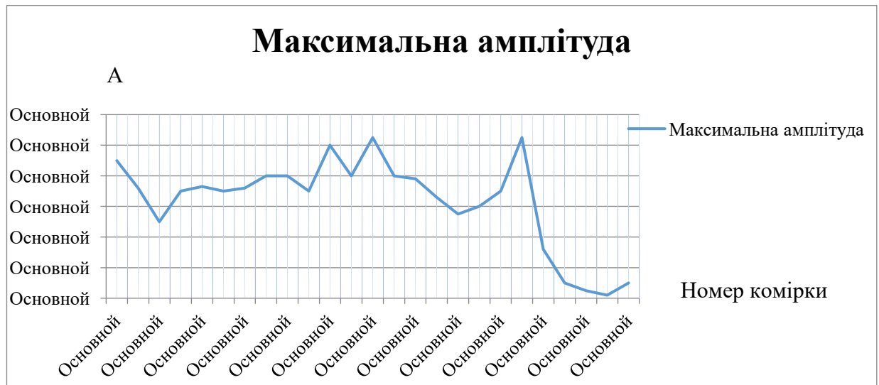
Рисунок 3.9 – Значення максимальної амплітуди сигналу у відповідних секторах (на основі аналогової інформації)
