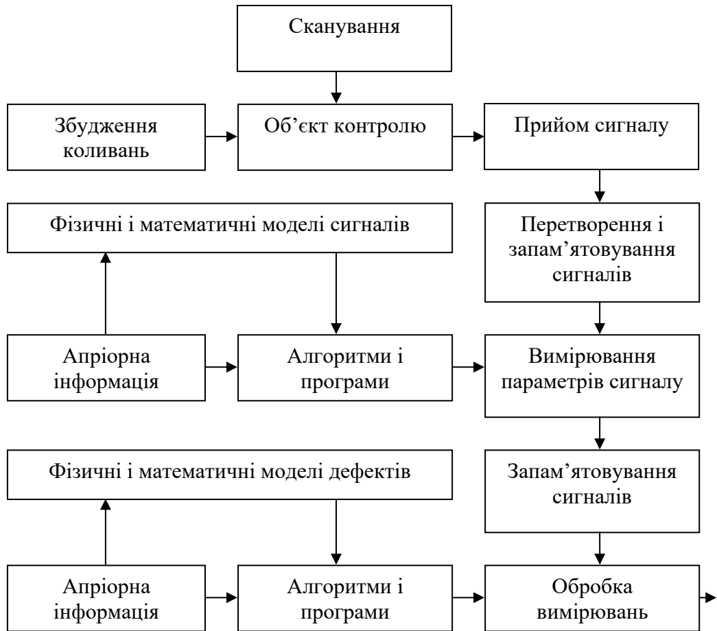
Рисунок 2.8 – Функціональна схема обробки вимірювань
