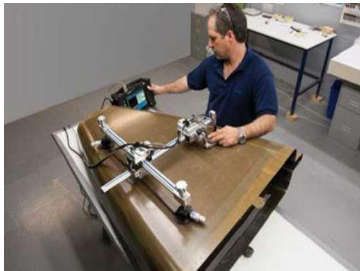
Рисунок 3.1 – Ручне сканування поверхні контрольованого об'єкта
