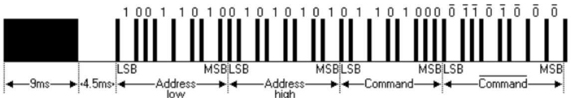
Рис.2.4. Передача з використанням протоколу NEC на 16 бітний адрес
