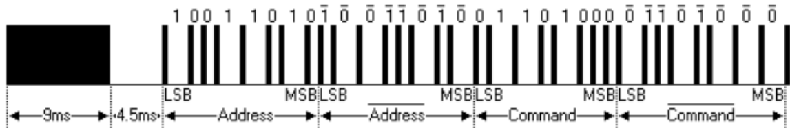
Рис.2.3. Передача з використанням протоколу NEC
