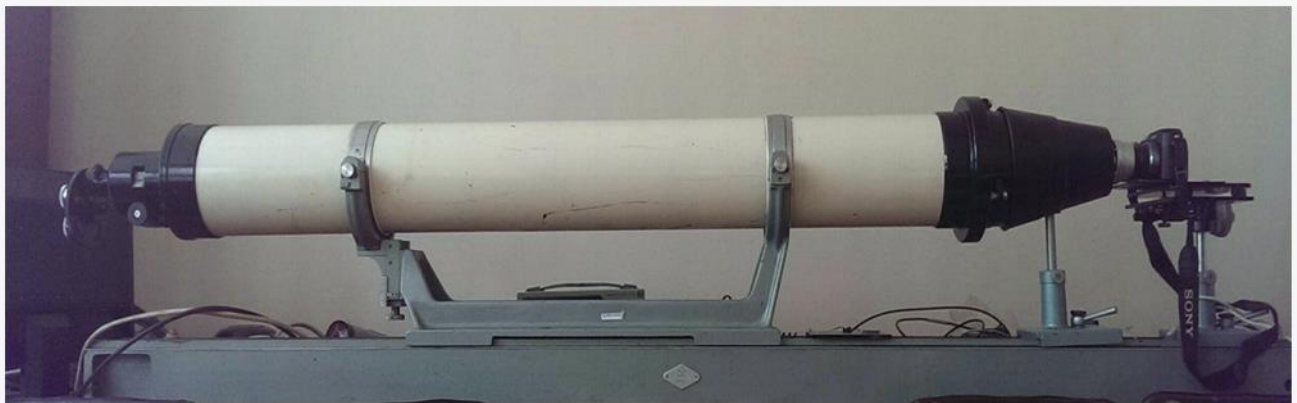
Рис. 4.3. Лабораторний стенд для визначення роздільної здатності цифрової аерофотокамери.
