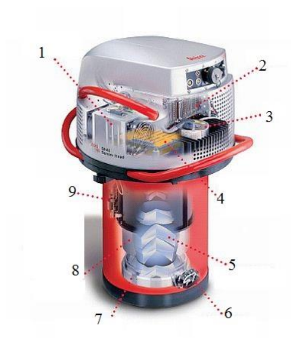
Рис.2.2. Будова цифрової аерофотокамери.
