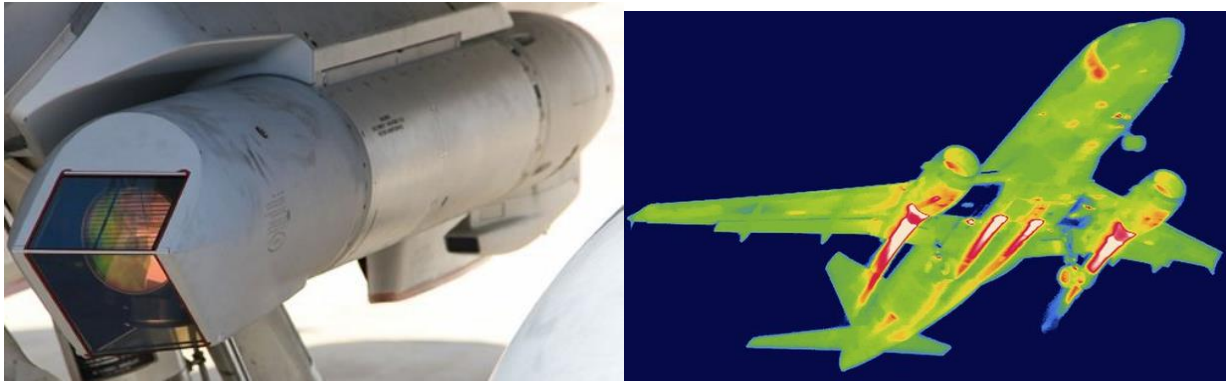
Рис. 2.3. Система FLIR та сформоване нею зображення.
