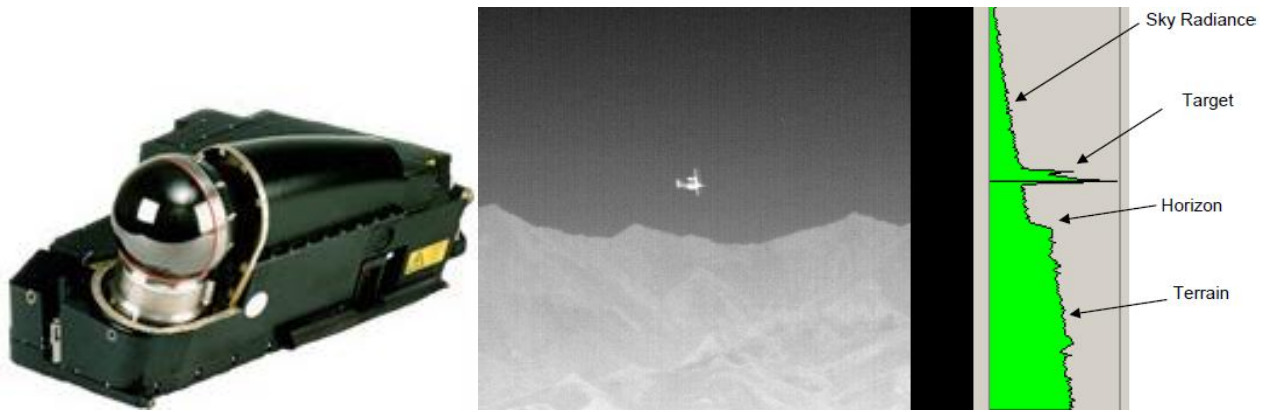
Рис. 2.2. Теплопеленгатор (IRST) та сформоване ним зображення.
