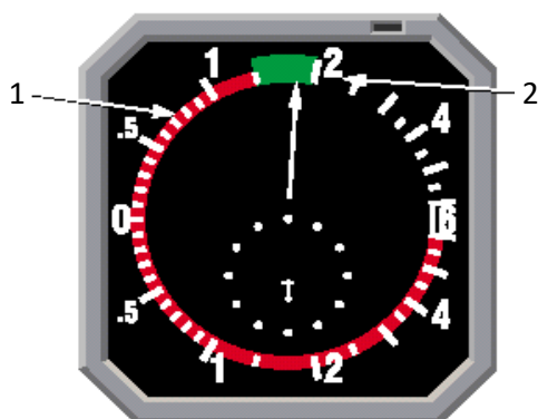
Рис. 1.5. Відображення рекомендації на дисплеї VSI/TRA: 1 –заборонена вертикальна швидкість «червона вузька дуга»; 2 – задана вертикальна швидкість «зелена широка дуга»
