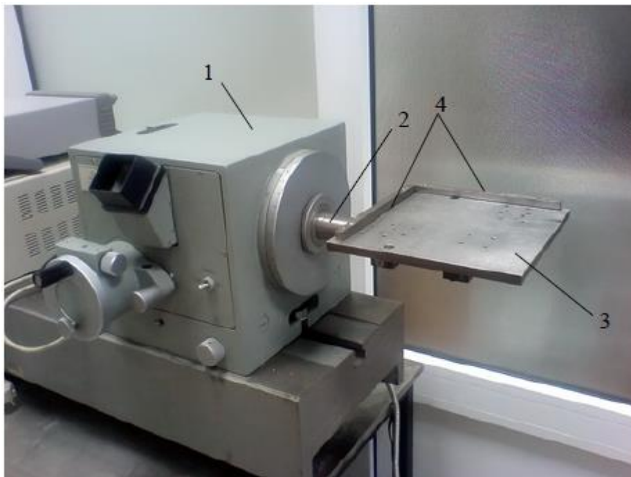
Рис.3.8. Оптична ділильна головка ОДГЕ-5 1 – ОДГ; 2 – вал; 3 – базовий майданчик; 4 – бічні бази
