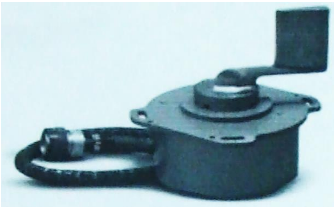
Рис 1.2 Флюгерний вимірювач кута атаки в корпусі
