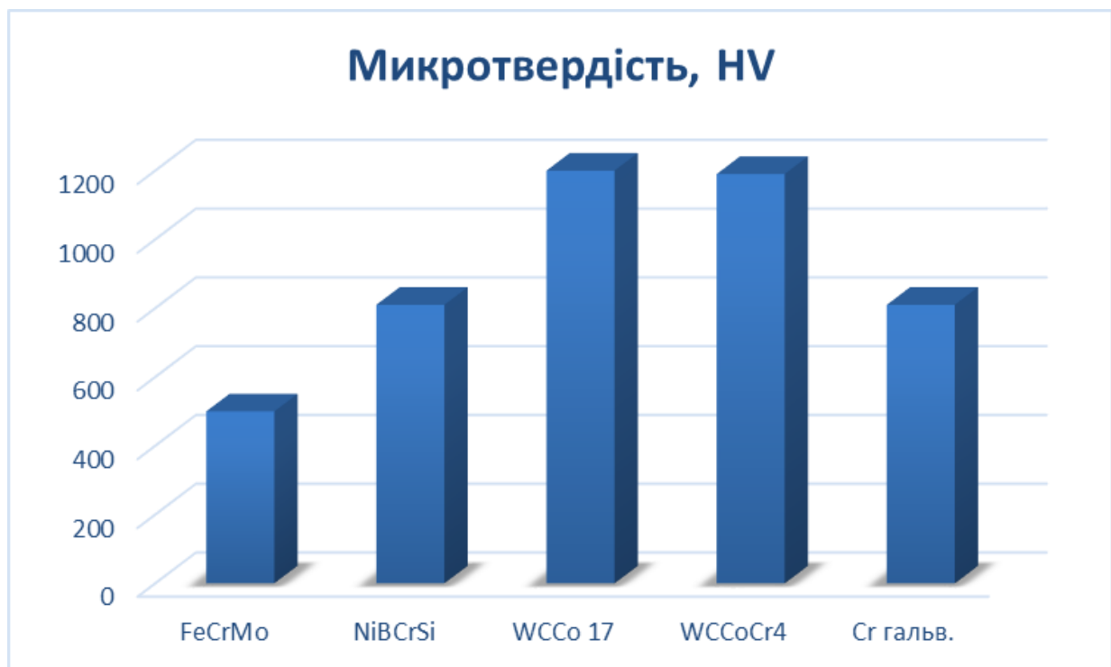
Рисунок 3.1 - Графік мікротвердості покриттів
