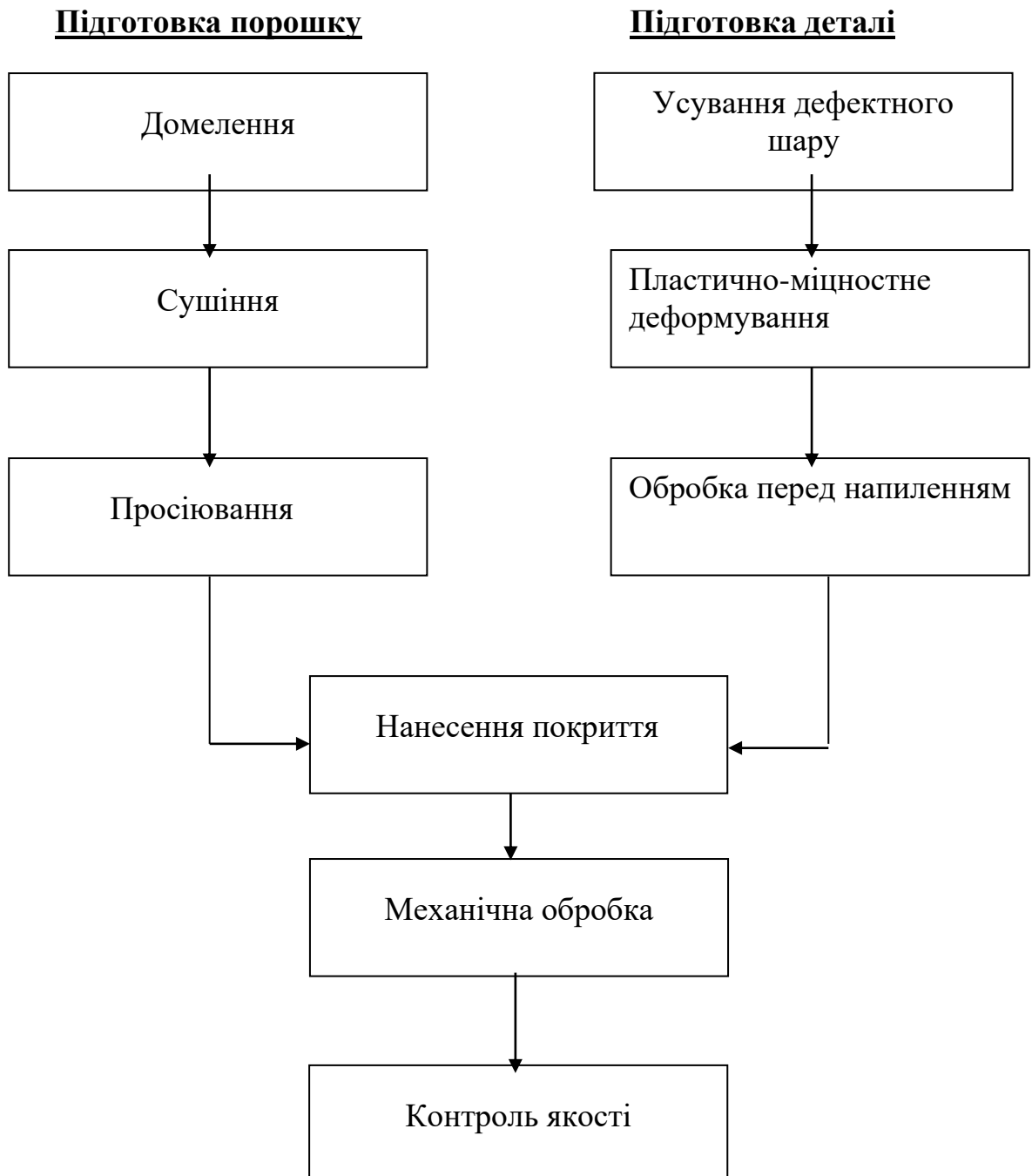
Рисунок 2.1 - Технологічний процес відновлення деталей авіаційної техніки газотермічними покриттями
