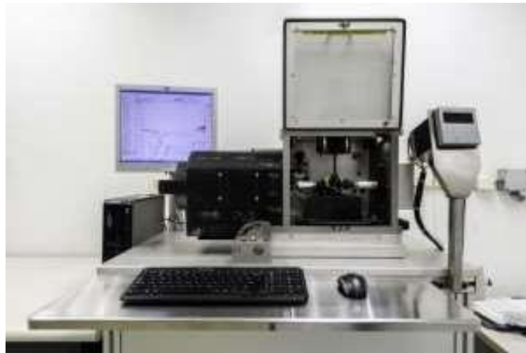
Рисунок 2.2 – Установка для дослідження трибологічних характеристик мастил SRV - III Test System
