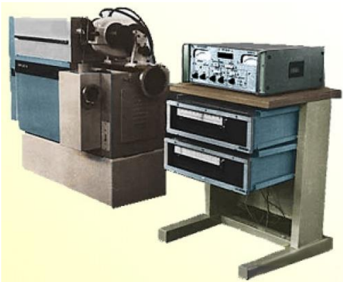
Рисунок 2.1 – Універсальна машина П5018 для випробування на тертя та зношування
