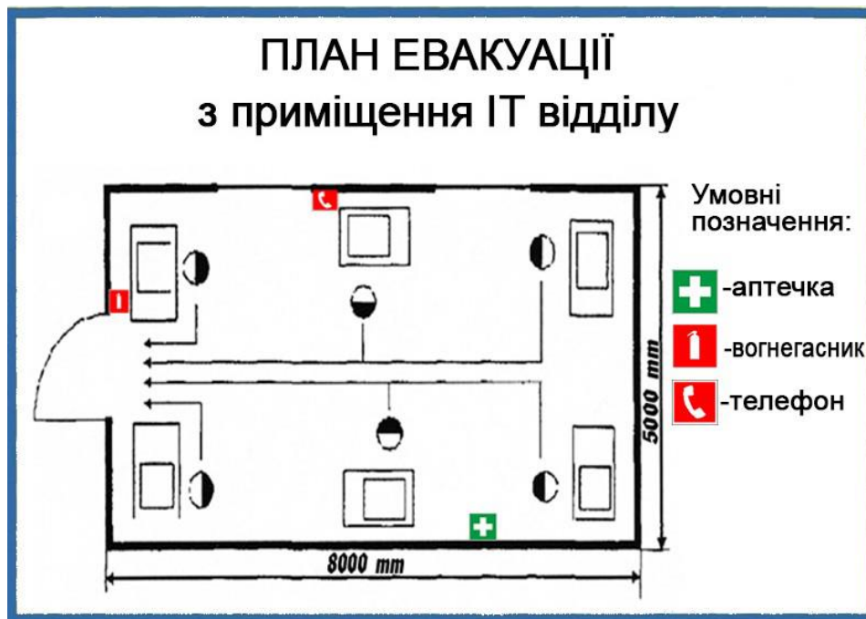
Рис. 5.1 План евакуації з приміщення ІТ відділу компанії
