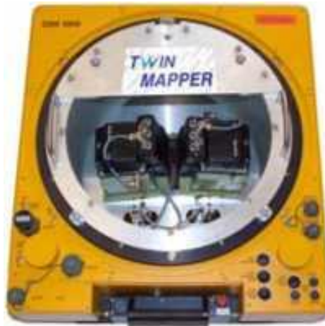
Рис. 1.7. Цифровий аерофотоапарат TwinMapper, встановлений на гіроплатформі GSM-3000
