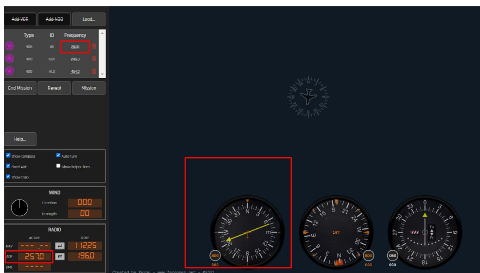
Рисунок 3.22 – Початок виконання місії політ до NDB
