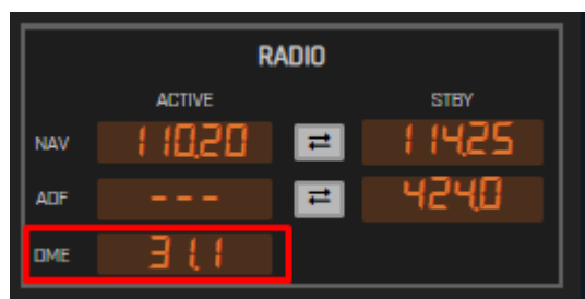
Рисунок 3.39 – Індикація відстані до пари VOR-DME
