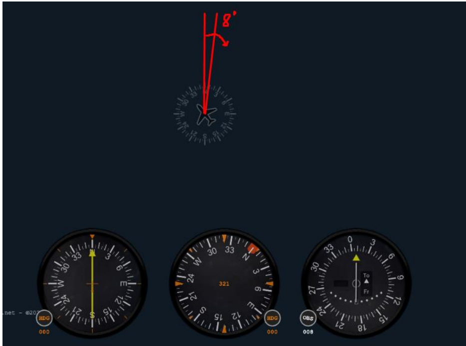
Рисунок 3.37 – Радіал як кут між напрямом на магнітну Північ і напрямом на маяк, незалежить від магнітного курсу літака
