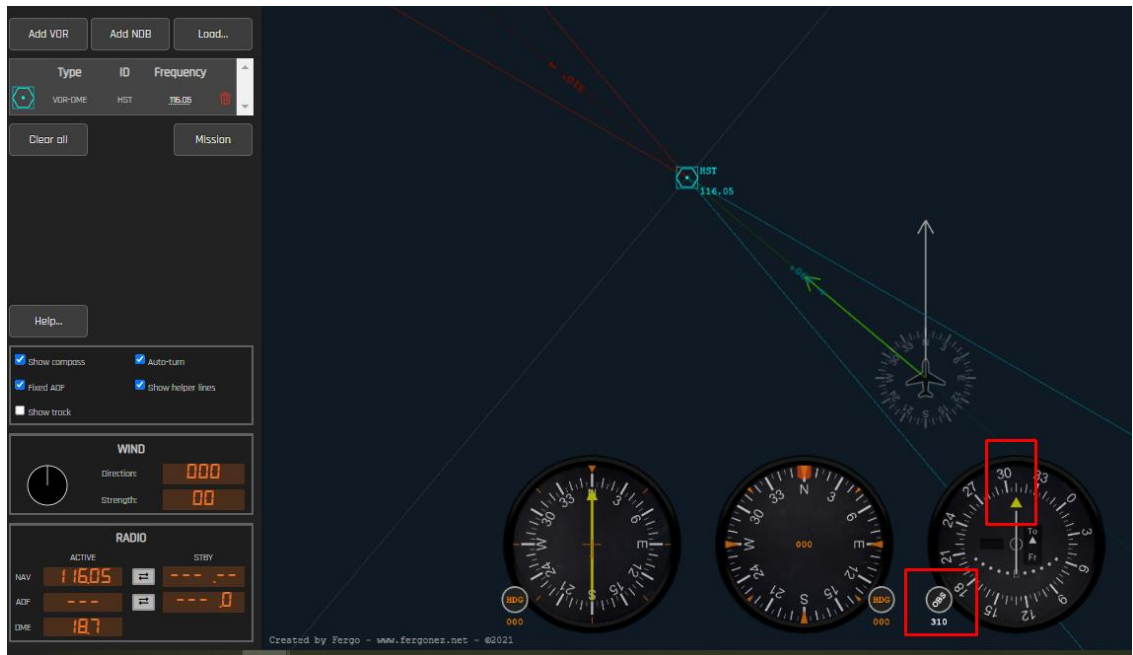
Рисунок 3.32 – Знаходження поточного радіала у напрямку на маяк VOR
