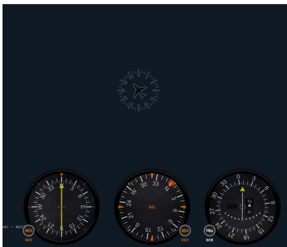
Рисунок 3.36 – Фіксація радіала на VOR маяк
