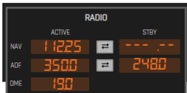
Рисунок 3.10 – Панель набору частот маяків VOR та NDB та індикації інформації від DME приймача
