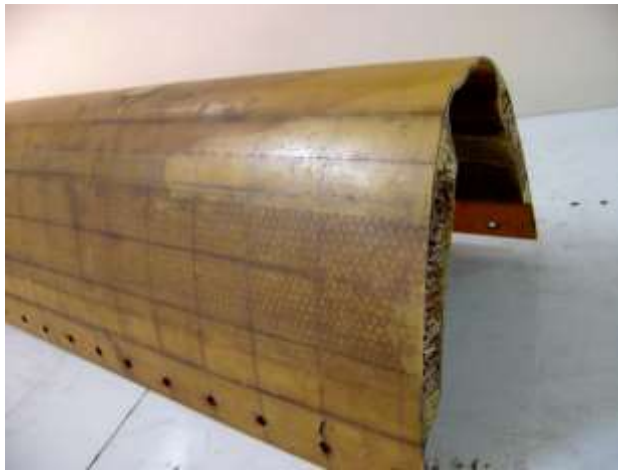
Рис. 3.5 Носок крила Ан-74 зі склопластику: а) схематичне зображення легкої та жорсткої тришарової сотової конструкції; б) фото пошкодженої зони.
