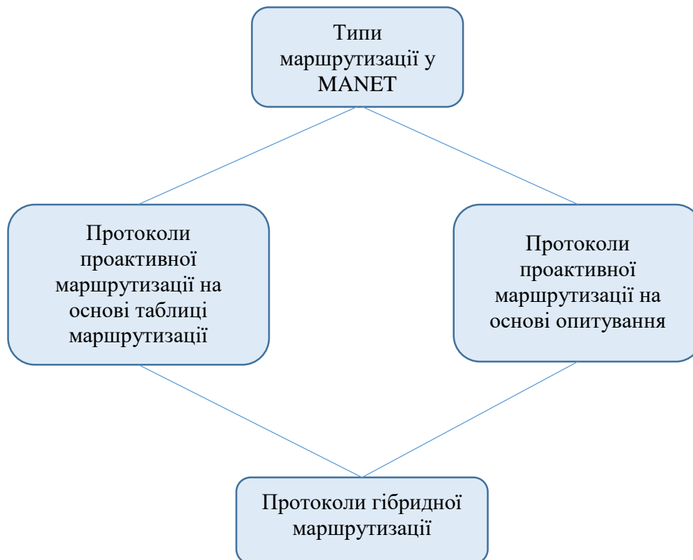
Рис. 2.1. Структурна схема протоколів маршрутизації мереж Mobile Ad Hoc Network
