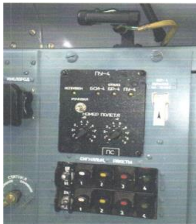
Рисунок 3.5 – Встановлення ПУ-4 та тумблера «Вкл. БУР на земле» в кабіні екіпажу
