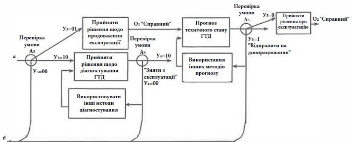
Рис. 2.9, б – Алгоритм моніторингу стану ГТД
