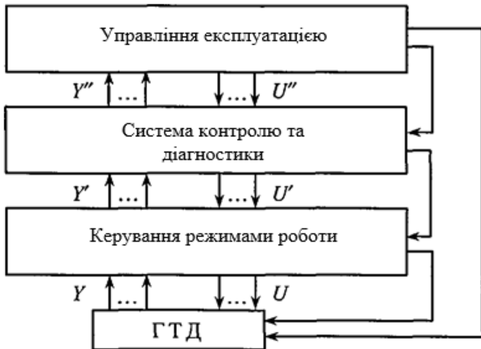
Рис. 1.1 – Функціональна схема багаторівневої системи управління ГТД
