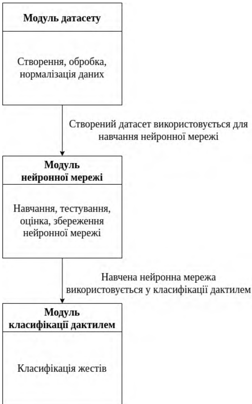
Рис. 2.2. Схема зв'язку модулів застосунку
