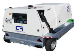
Рис. 3.8. Наземний блок живлення GUINAULT GA 180
