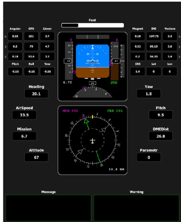
Fig. 5. UAV parameters display interface
