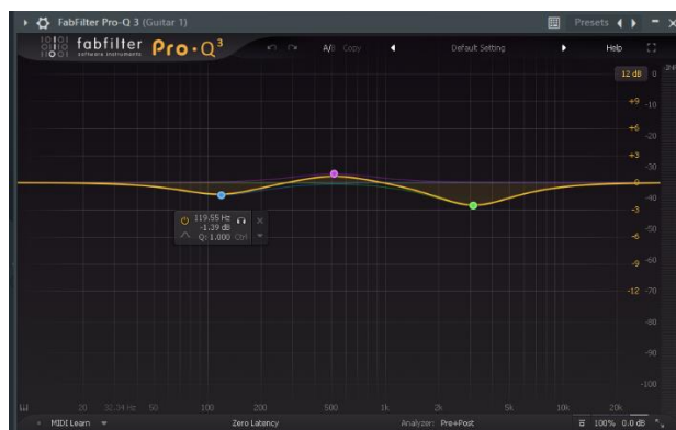
Рис. 3.9. Еквалізації гітарної партії за допомогою плагіну FabFilter Pro Q-3
