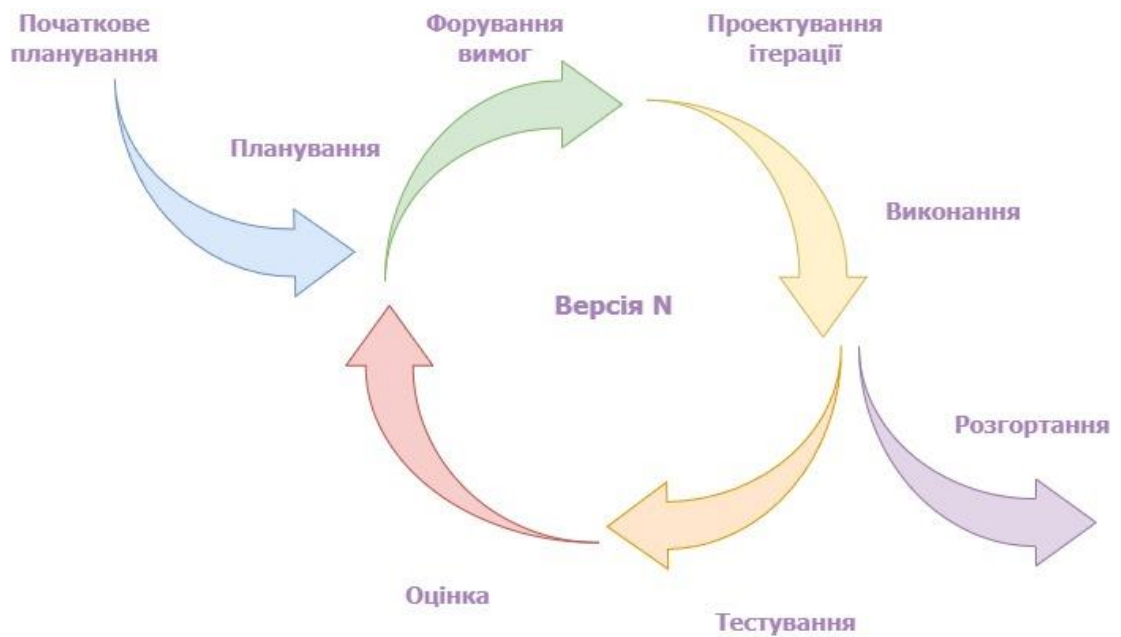
Рисунок 3.3 Інкрементна модель розробки програмного забезпечення
