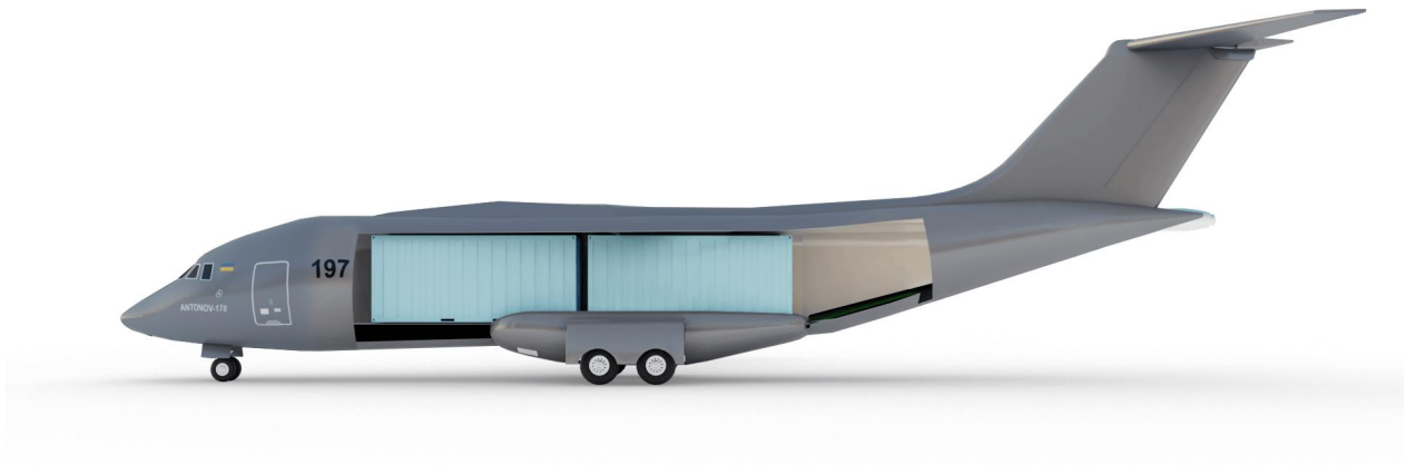
Рис.2.8. Зображення вантажного відсіку АН-178 з двома 20 – футовими контейнерами [18].
