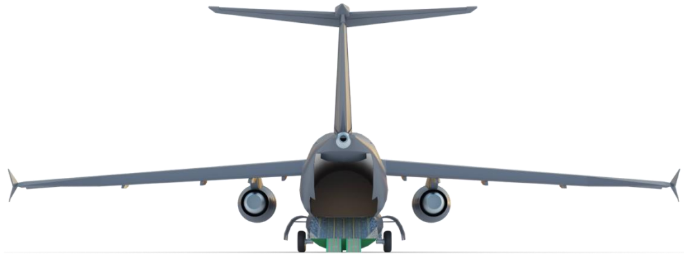
Рис.2.7. Ан-178 вигляд задньої завантажувальної сторони повітряного судна[18].
