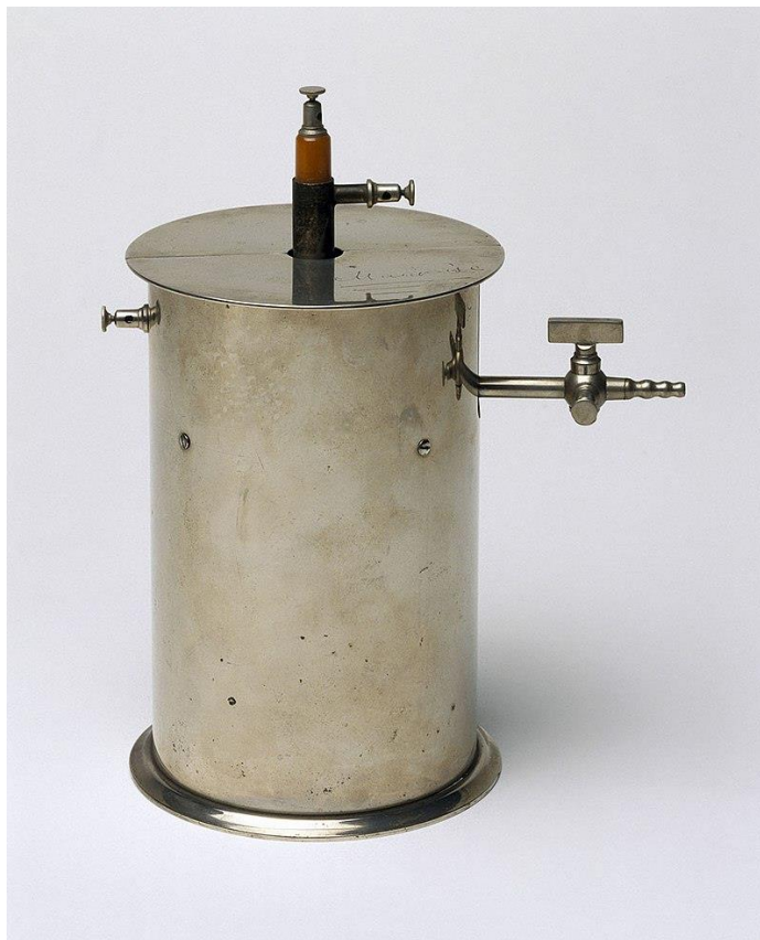
Рис. 2.3. Іонізаційна камера, яку використовував П'єр Кюрі (1895–1900)
