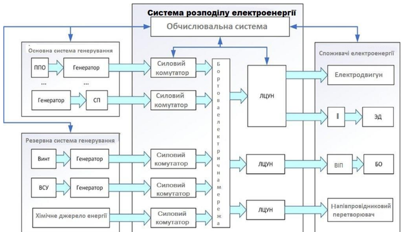
Рис. 2.1. Система розподілу електроенергії на ПК
