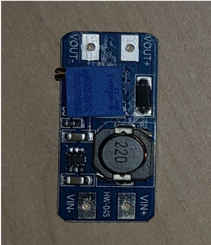
Рис.4.8. Мініатюрний регульований підвищуючий перетворювач (MT 3608).
