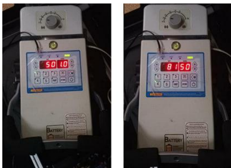
Рис. 3.12. Рентгенівський випромінювач налаштований на різні параметри експозиції (зліва – режим прогріву 50 кВ 1 мАс; справа – робочий режим 81 кВ 50 мАс).
