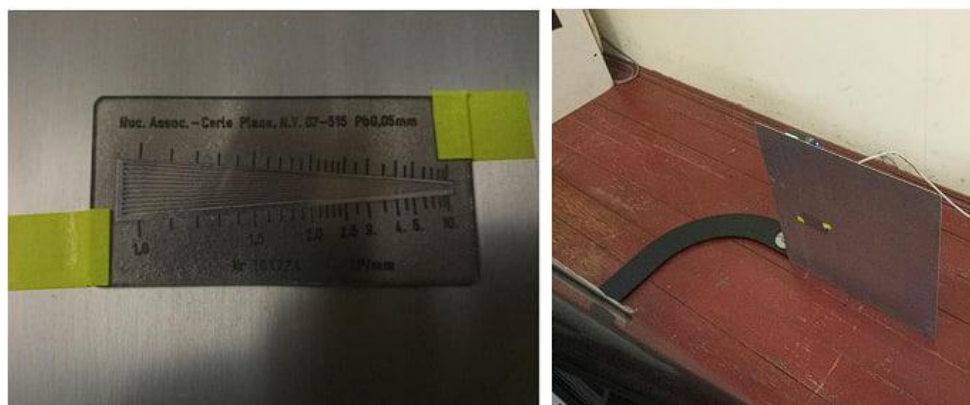
Рис. 3.12. Рентгенівська міра, закріплена на фільтрі (лист алюмінію Al товщиною 4 мм), та встановлена перед входним вікном приймача.
