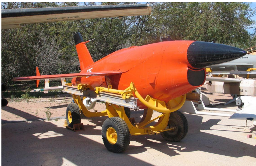
Рис.1.6. Реактивний БПЛА Ryan BQM-34 Firebee, який використовується як дрон-мішень [7]
