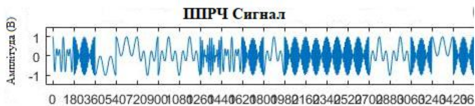
Рис.1.17. Приклад ППРЧ модульованого сигналу
