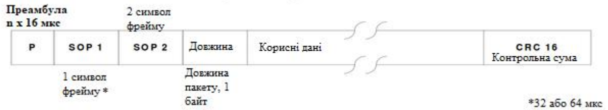
Рис.1.18. Приклад пакету DSM2/DSMX
