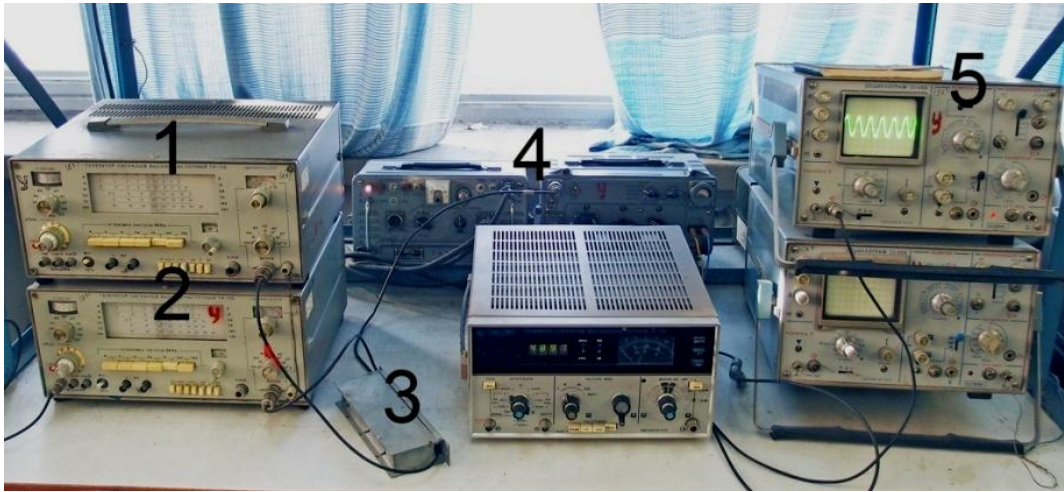
Рис.3.1.2 – стенд для демонстрації явища блокування на базі радіостанції «P-802M2»
